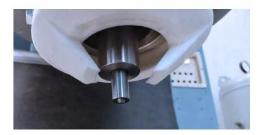
Вращающийся инструмент погружается в стык между деталями, и, вращаясь, движется вдоль стыка, при этом достигается 70% температуры плавления материала, а также осуществляется перемешивание материала за счёт специальной геометрии инструмента.
