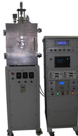
Рис. 5. Внешний вид установки VSM-BASIC компании ROBvac
