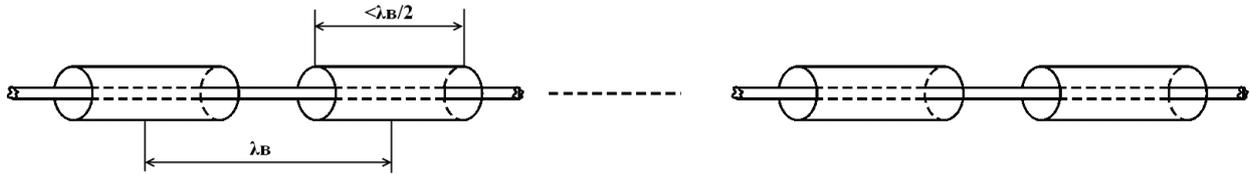
Рис. 2. Переизлучатели, устанавливаемые вдоль линии
