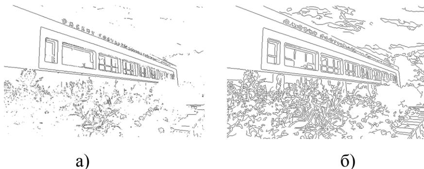
Рисунок 2.17 – Анализ границ: а) границы, полученные с помощью фильтра Собела; б) границы, полученные с помощью фильтра Кэнни
